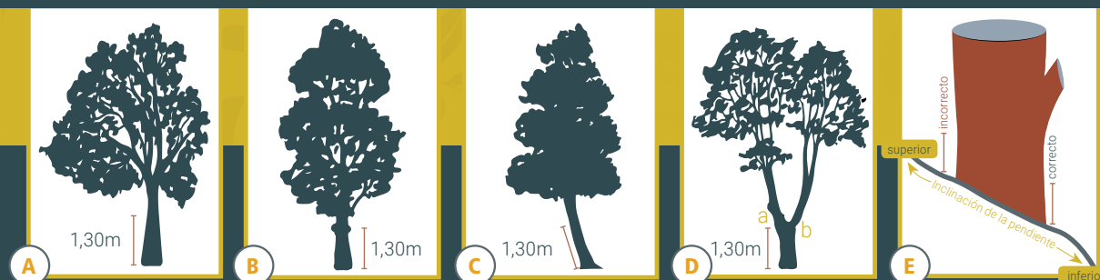
Figura 10. Medición de individuos con DAP ≥ 5 cm. A) Medición normal del diámetro a 1,30 m. B) Cambio de punto de medición del diámetro por interferencia de nudo a 1,3 m. C) Cuando un árbol se encuentra inclinado, se debe medir el 1,3 m por la cara interna que enfrenta el suelo. D) En individuos multifustales se considerará todos los tallos con por lo menos 5 cm de diámetro de fuste, en caso de que sea medido a 1,30 m desde la base. E) En pendiente, se mide 1,3 m desde la parte baja de la pendiente. Fuente: Adaptación de Osinaga-Acosta et al. 2014
